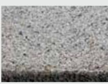
ブロック内部に雨水等を保水して、表面から水分が大気中に蒸発する際に周辺の熱を下げます。ヒートアイランド現象の抑制に効果を発揮します。
